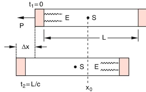
**Abbildung 4.30** Einsteins Gedankenexperiment zur Herleitung von  $E = m \cdot c^2$
