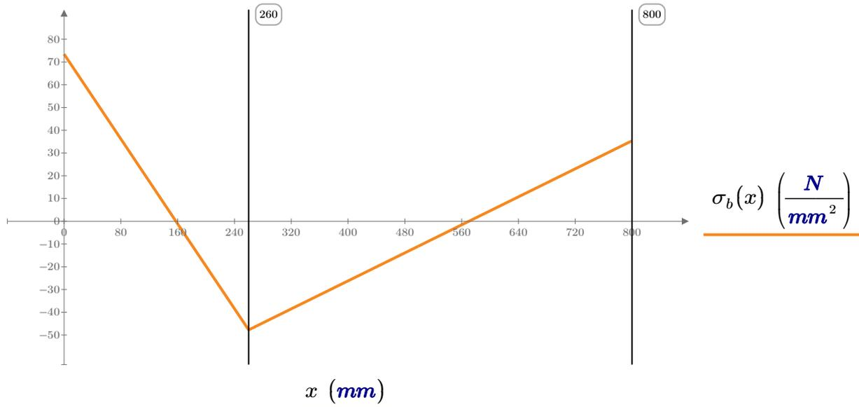
Die maximale Durchbiegung tritt in diesem Beispiel im linken Trägerabschnitt auf:
