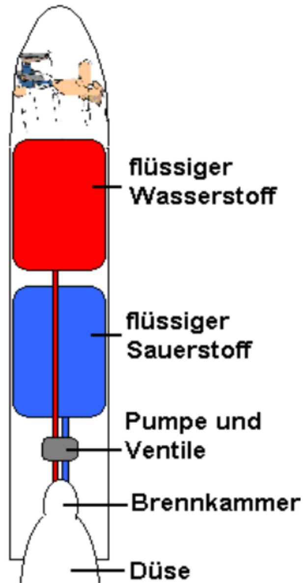
Abb. 1 Prinzipieller Aufbau einer Rakete
